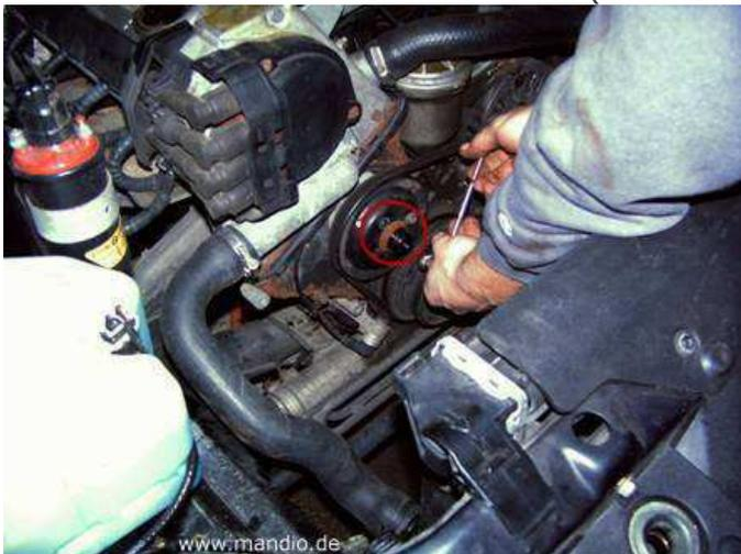
Wenn die Keilscheibe gelöst ist, wird die WaPu etwas widerspenstig und lässt sich nur sehr schwer rauskriegen, doch dem kann man elegant abhelfen. Man nimmt sich einen Hebel, der direkt unter die Tellerbesfestigung der WaPu ansetzt. Diesen versetzt man durch etwas Druck am Hebel und durch leichte Schläge mit einem Hammer (Gummi oder ähnlichem).
