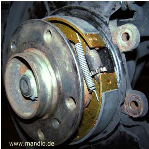
Die Bremsbacken sind jetzt drin, nun müsst ihr die Scheibe vorbereiten bzw. von dem Schutzfilm und Fett befreien (Bremsenreiniger). Bevor die Bremsscheibe rauf kommt, muss man mit dem Spanner die Beläge auseinander treiben (siehe Pfeil), bis die Scheibe geradeso raufpasst.
