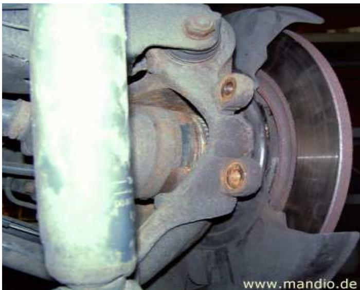
Jetzt sollte Ihr die Bremsscheibe abziehen können (**Wichtig!** Die Handbremse sollte gelöst sein). Falls es etwas schwerer geht, ruhig mit dem Hammer leicht auf die Außenseite der Trommelwand schlagen.
